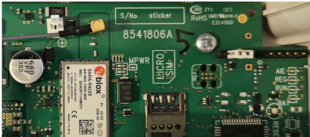
Kuva 6 Antenni liitetään radiomoduulin yläpuolella olevaan MMCX-liittimeen
