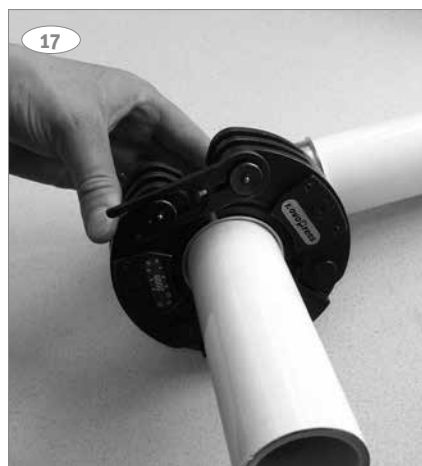
14: Aseta puristuskaulus PressCheck®-puristusrenkaaseen.
