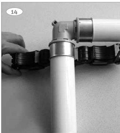
14: Aseta puristuskaulus PressCheck®-puristusrenkaaseen.
