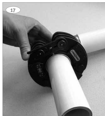
14: Aseta puristuskaulus PressCheck®-puristusrenkaaseen.
