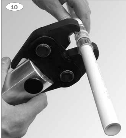
10: Aseta puristus pää (16 - 32 mm) puristusrenkaaseen muoviosan ja puristusrenkaan pullistuman väliin.
