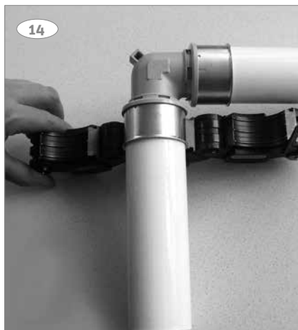
14: Aseta puristuskaulus PressCheck®-puristusrenkaaseen.
