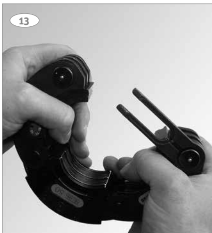
13: 40, 50 ja 63 mm:n puristuksissa käytetään Roth-puristuskauluksia. Avaa puristuskaulus jousitetun pultin avulla.
