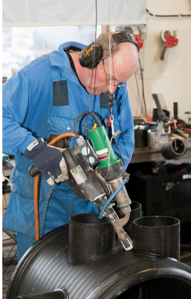
Kim Broman tekee kaivosta tiiviin ekstruusiohitsauksella.
